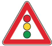
F.R 190 031 A semaforo con lanterne verticali
