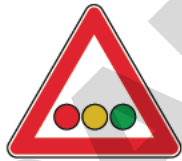
F.R 190 031 B semaforo con lanterne orizzontali
